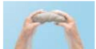
混合色がグレーになれば接着や穴埋めをする部分に塗り付け、硬化するまで静止してください
